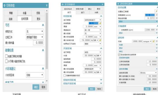
图3-20 叶背半精加工1 切削模式及参数设置
