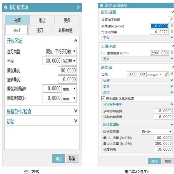
图 3-26 进刀方式、转速和进给
