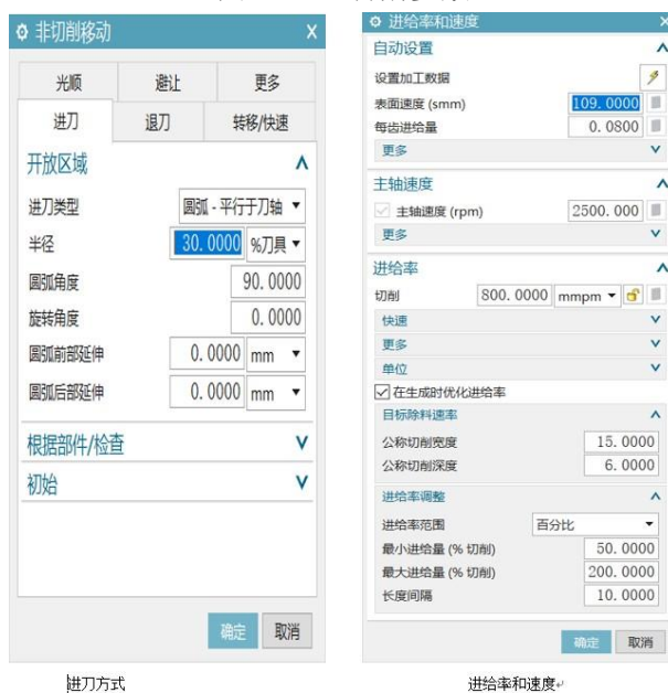
图 3-30 进刀方式、转速和进给
