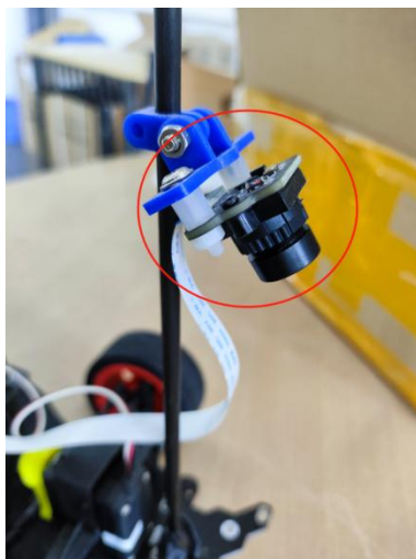
图 2-5 摄像头的安装
