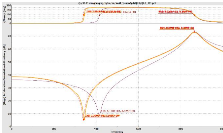
图 4-20 修改后轮辋侧向频响函数
