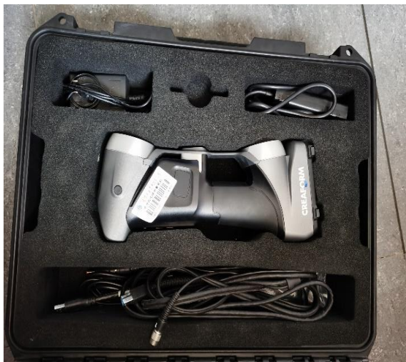
图 3-1-1 Handyscan700 三维激光扫描仪
