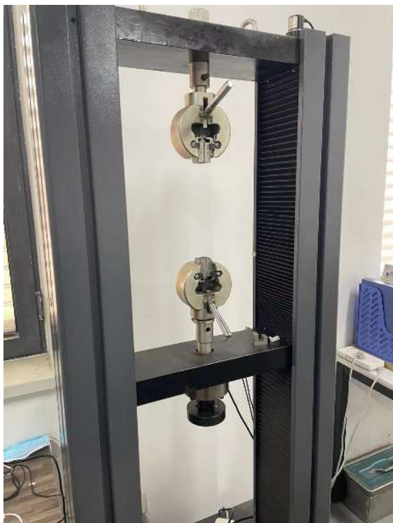
图 3-1 微机控制电子万能试验机
