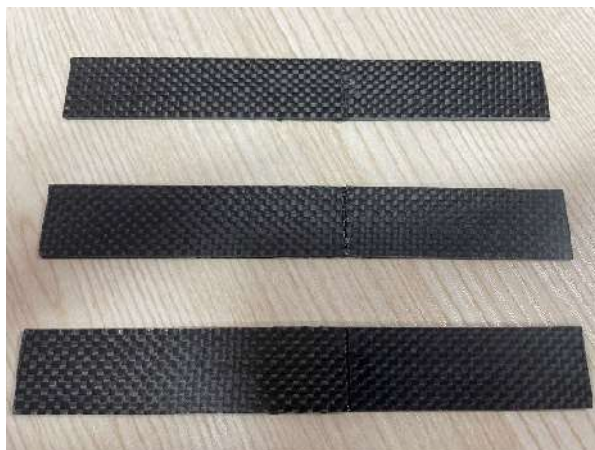
图 2-12 三组不同斜率连接的复合材料板
