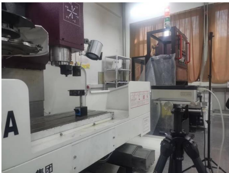
图 3-9 对 Z 轴螺距误差测量中设备搭建图
