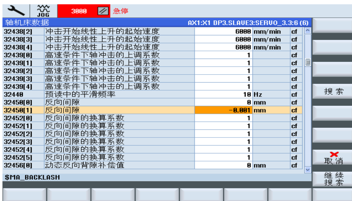
图 2-13 SIEMENS 系统中反向间隙补偿值的输入界面
