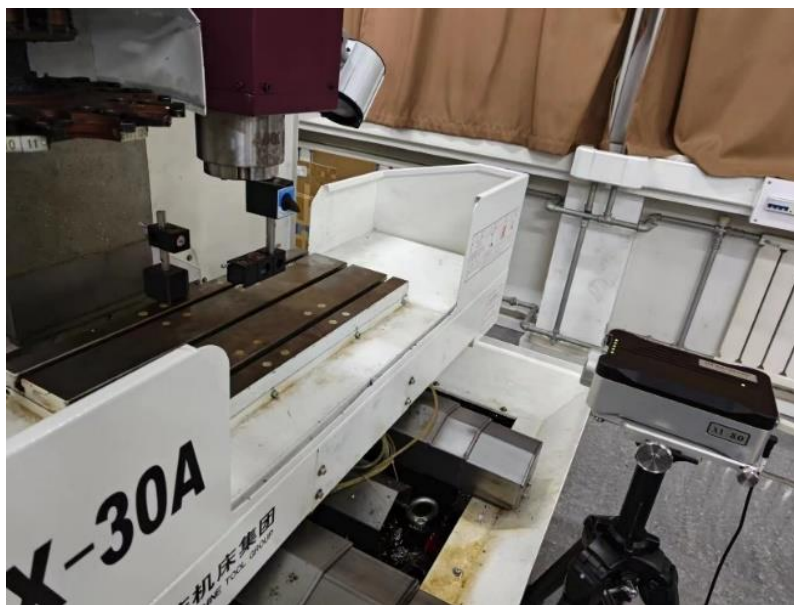
图 3-6 对 Y 轴螺距误差测量中设备搭建图
