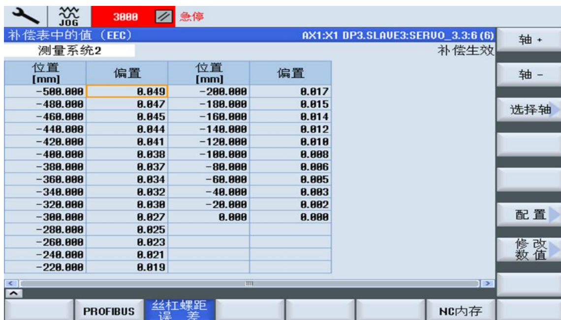
图 2-12 SIEMENS 系统中螺距误差补偿参数与数据的输入界面
