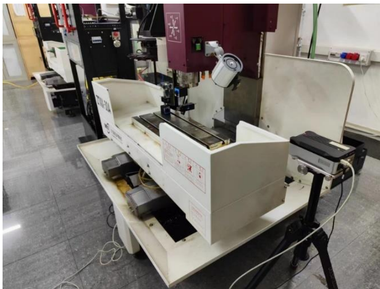
图 3-3 对 X 轴螺距误差测量中设备搭建图
