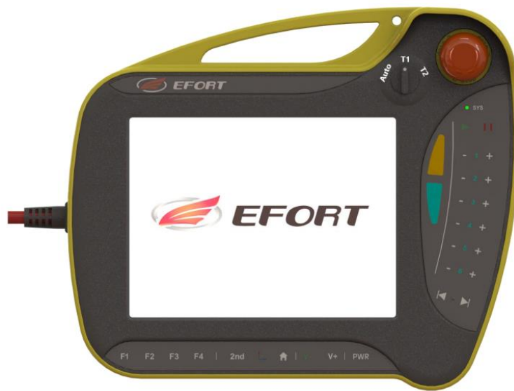
图 2-3 工业机器人示教器示意图
