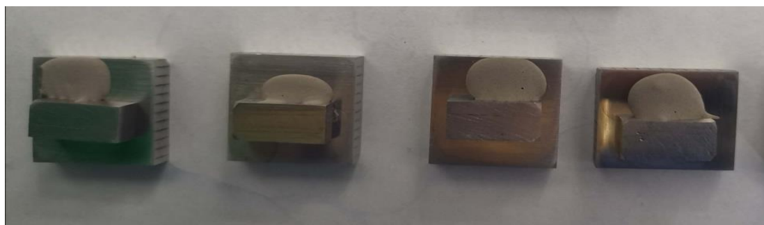
。图 3-4 钎料注入完成图
