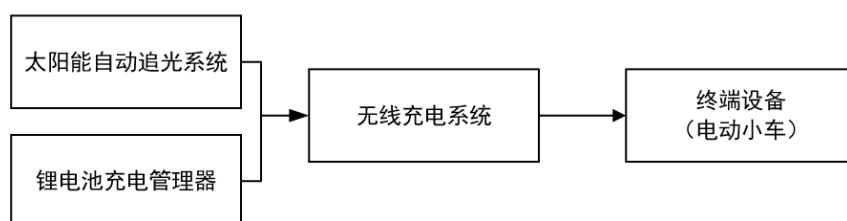
图 1-2 系统总体结构框图
