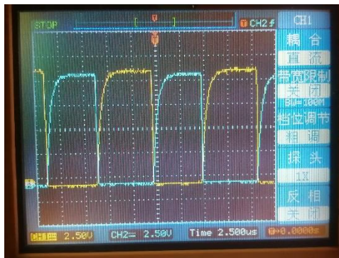
图 4-6 振荡器输出的 100KHz 方波信号
