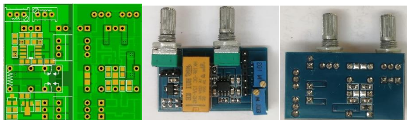
图 2-5 信号处理电路 PCB 设计图及实物正反面
