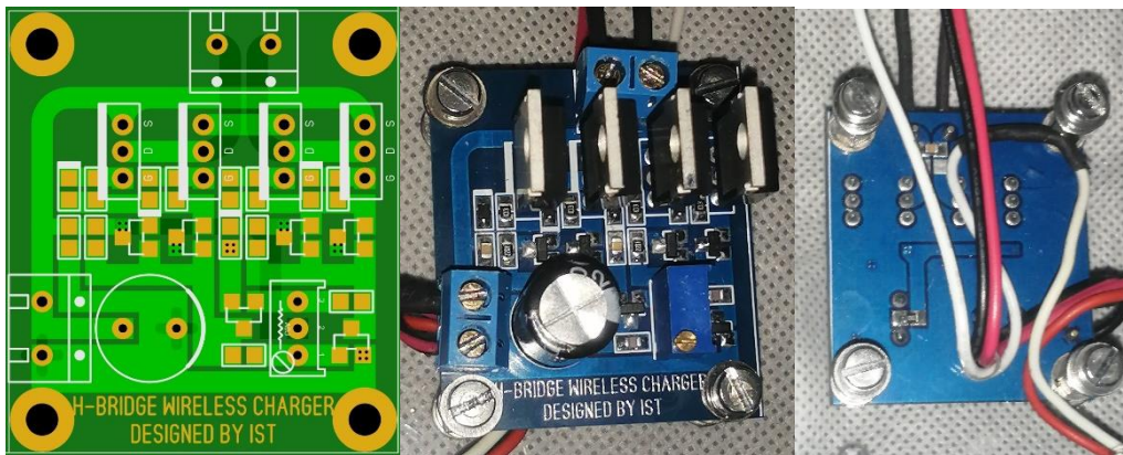
图 2-23 无线电发射端电路 PCB 设计及实物正反面装配图
