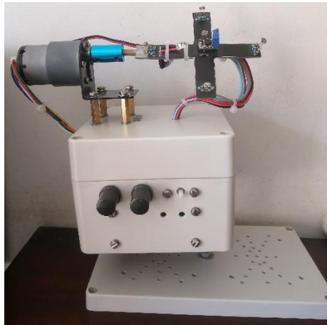
图 4-5 太阳能自动追光系统试制测试样机
