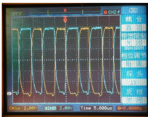
图 4-7 H 桥输出的 100KHz 方波信号
