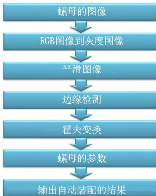
图 1 用于自动装配的螺母识别过程
