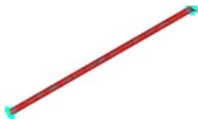
图 4-6 管路端面约束施加图
