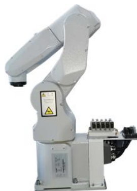
图 3-23 ER3B-C30 工业机器人
