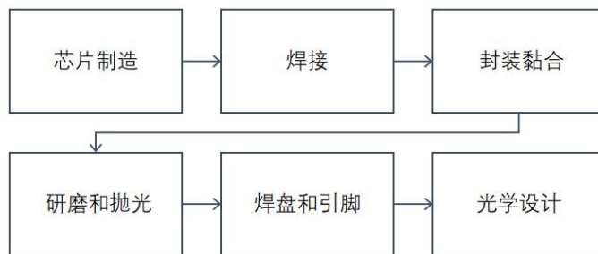
图 3-1 LED 日光灯制造工艺
