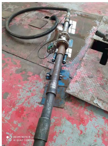
图 6-4 流量计实际工况现场测试图
