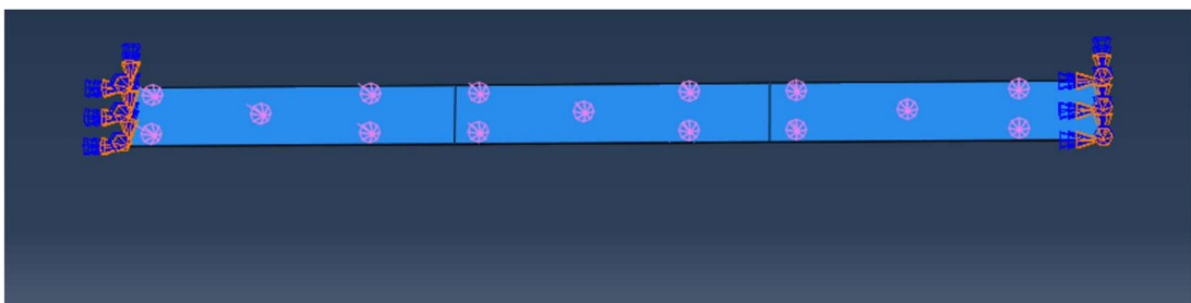
4.11 对两个“试样级”有限元模型施加弯曲载荷
