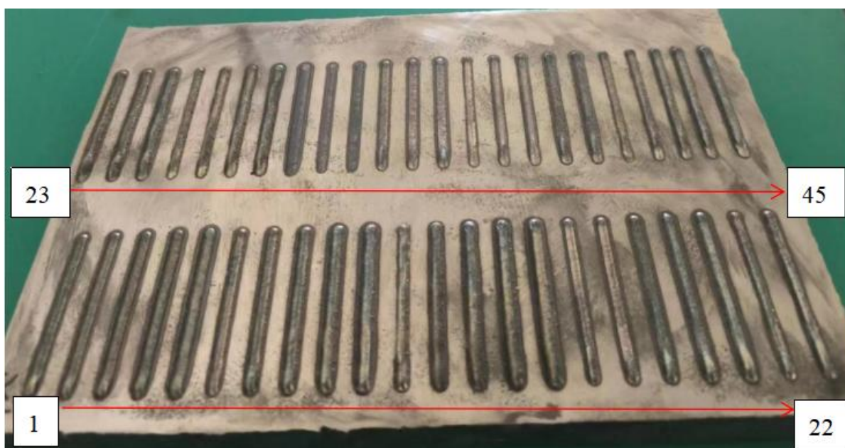
图 3-1 单道激光熔覆实验成型情况
