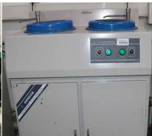
图 2-3 P-2G 金相试样抛光机
